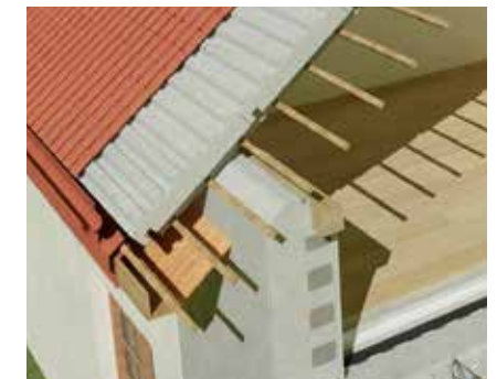
Esquema de la conexión la placa de techo Izodom con la pared.
