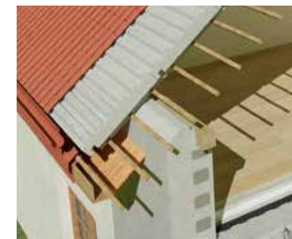
Izodom jumta plāksnes savienošanas shēma ar sienu.
