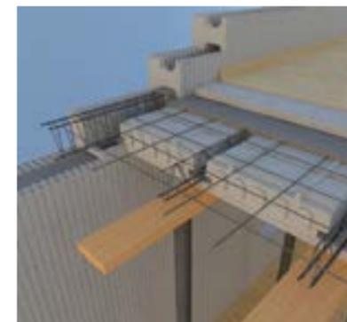
Auf den Deckenformteilen und der Bewehrung und die Bewehrung verlegt man den Beton. Er füllt die Vertiefungen aus, formt die konstruktiven Stahlbetonbalken und bildet gleichzeitig oben eine tragfähige Schicht. Die Decke verbindet sich monolithisch mit den Wänden in der Ringankerebene und bildet so eine kompakte und beständige Konstruktion.
