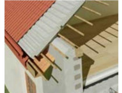
Verbindungsschema der Dachplatte von Izodom mit der Wand.
