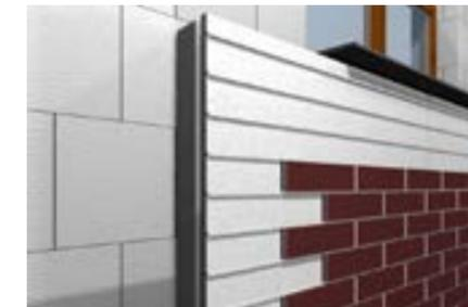
Funktionsschema der Platte IZOALFA
