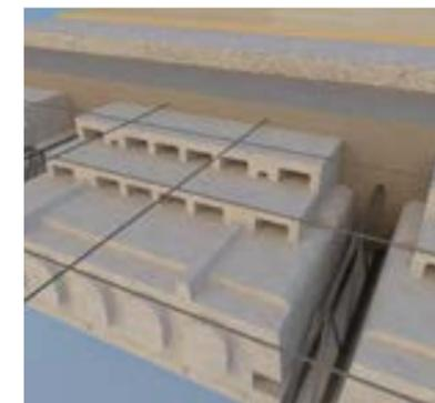
Beim Bau einer Decke mit einer großen Spannweite oder hohen Belastungen kann man die konstruktive Tragfähigkeit des Balkens (Rippe) anheben. Verlegt man auf den Deckenformteilen STP zusätzlich die Deckenaufsatzelemente STN mit einer Dicke von 5 cm, wird bewirkt, dass sich die Höhe der Rippe vergrößert. Die Standardhöhe der Rippe, das sind 20 cm, mit einem Aufsatz STN dann 25 cm und mit zwei Aufsätzen STN 30 cm.
