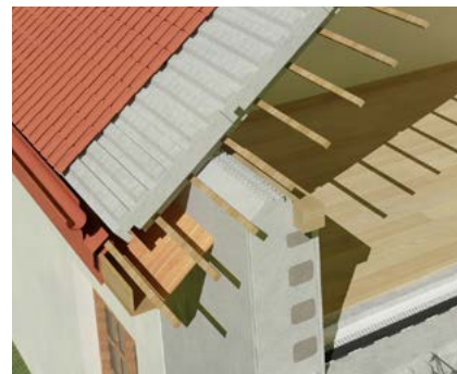
Schematische weergave van de aansluiting van de dakisolatie op de muurisolatie.
