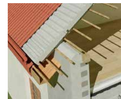
Schéma de jonction de la dalle de toiture Izodom avec le mur.
