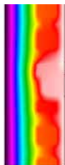
L'élément de couronnement MP possède une couche interne d'isolation, identique à celle du mur entier.
